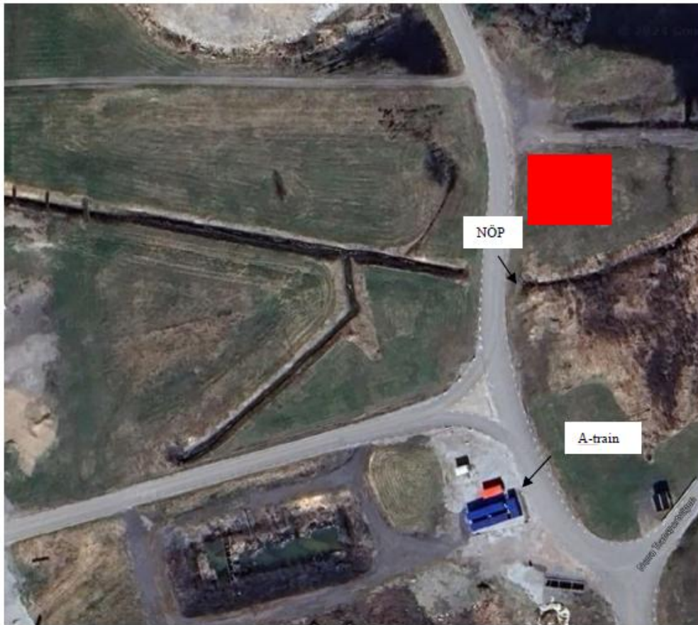
Figur 7. Mätpunkt NÖP med föreslaget läge för temporär reningsanläggning (röd kvadrat) samt befintlig anläggning (A-train)
