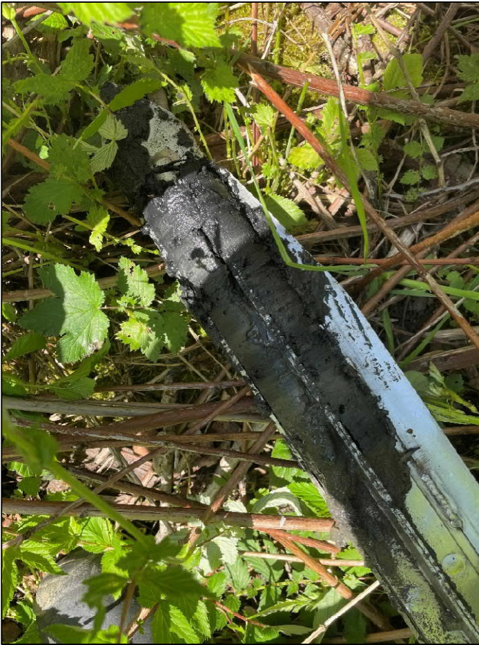
Figur 9. Sedimentprov uttaget med ryssbör.
