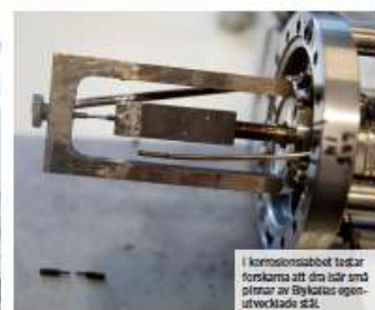
I korrosionscellen testas forskarna att den lätt små plåtar av Blykallas öppentvåkade stål.
