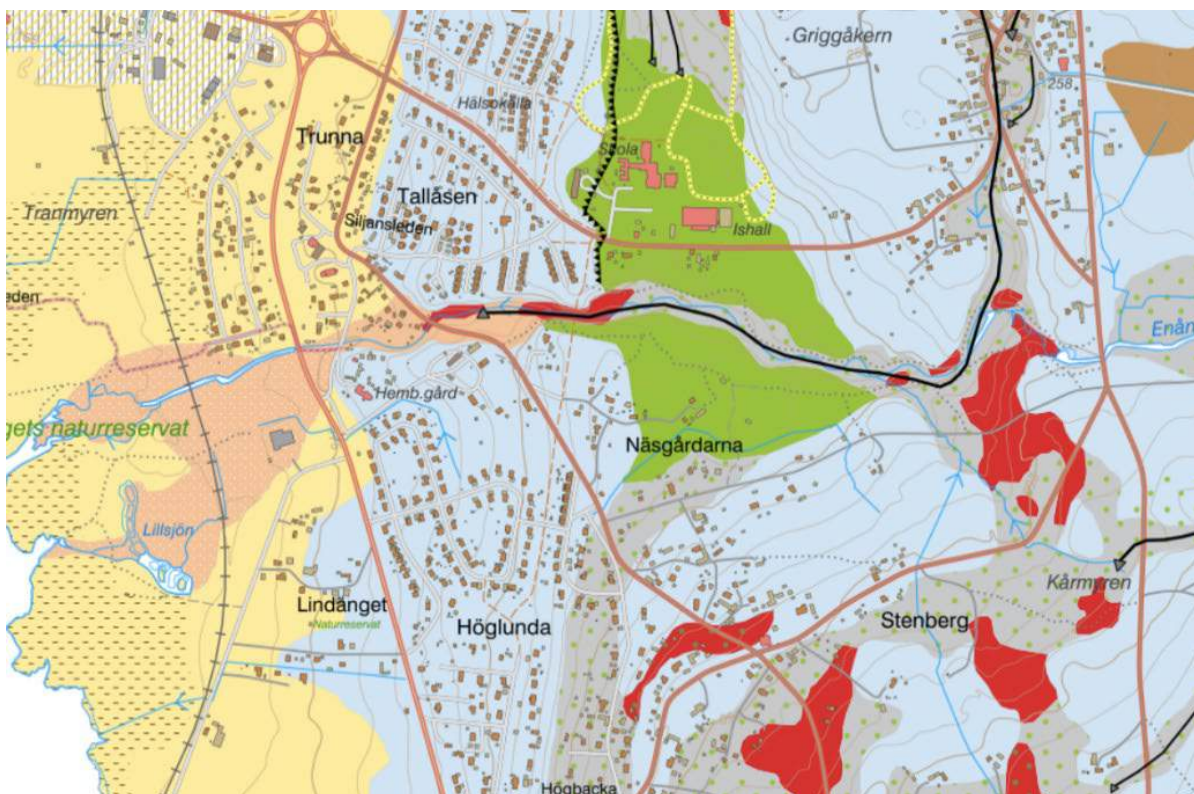
Figur 27. Isälvsediment markerat med grönt. Grått är isälvsroderat material och i nedre delen vid bron (ljusbrunt) älvsediment med sten-block. Där Enån fortsätter västerut utgörs däremot älvsedimentet av grovsilt-finsand. Den svarta pilen från norr är en stor smältvattenränna. Ljusblått är morän och rött utgör berg. © Sveriges geologiska undersökning.
